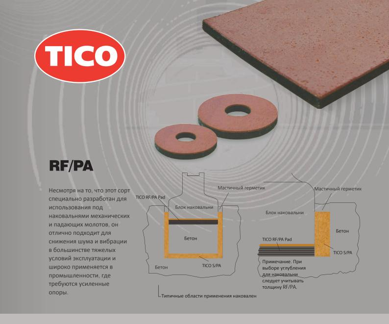
TICO RF/PA — это материал для прокладок с высокой несущей способностью, состоящий из слоев синтетического каучукового хлопка с прослойками неопренового каучука, модифицированного ячеистыми частицами. Одна сторона покрыта тонким слоем резиновой пробки для поглощения неровностей на посадочной поверхности. Он устойчив к воде, маслу, охлаждающим жидкостям и другим средам, обычно встречающимся в тяжелой промышленности.
